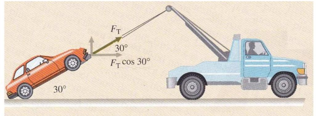
Une dépanneuse remorque une voiture en panne. La tension du câble est constante et les deux véhicules ont une accélération constante.
